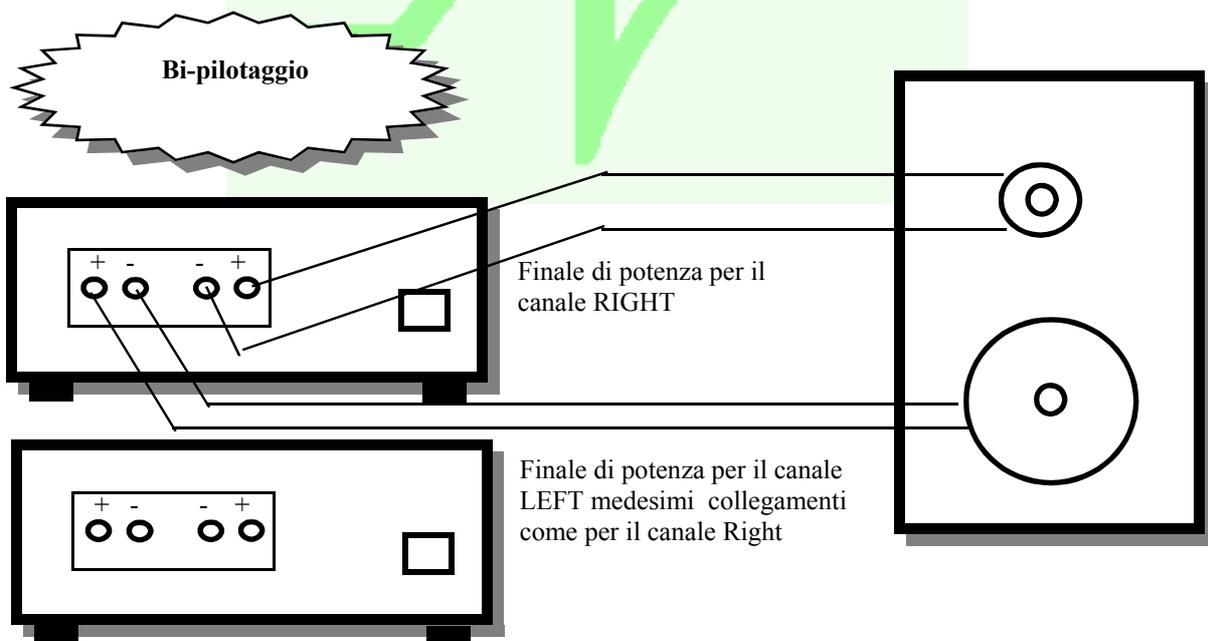
Con questo schema di collegamento si raddoppia la potenza e la timbrica rimane invariata. I finali di potenza sono pilotati dal preamplificatore con segnale mono perciò occorre un cavo di interconnessione che porti il segnale in entrambi gli ingressi RCA per pilotare i canali interni del VM-150 così da trasformare un finale in mono per RIGHT e l'altro per il LEFT.
