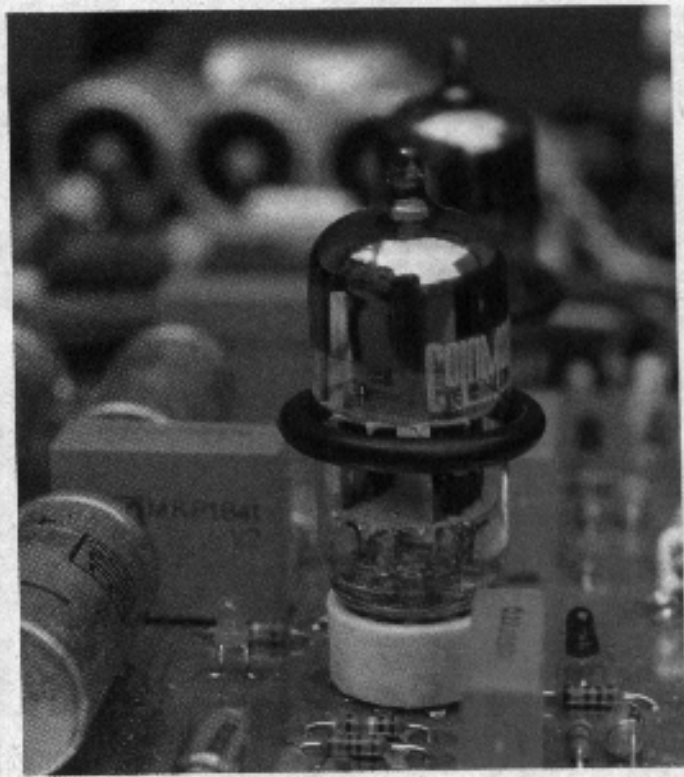
Le due ECC 81 selezionate per l'amplificazione dello stadio phono. Si nota l'anello di gomma con funzioni smorzanti per ridurre la microfonicità delle valvole.
